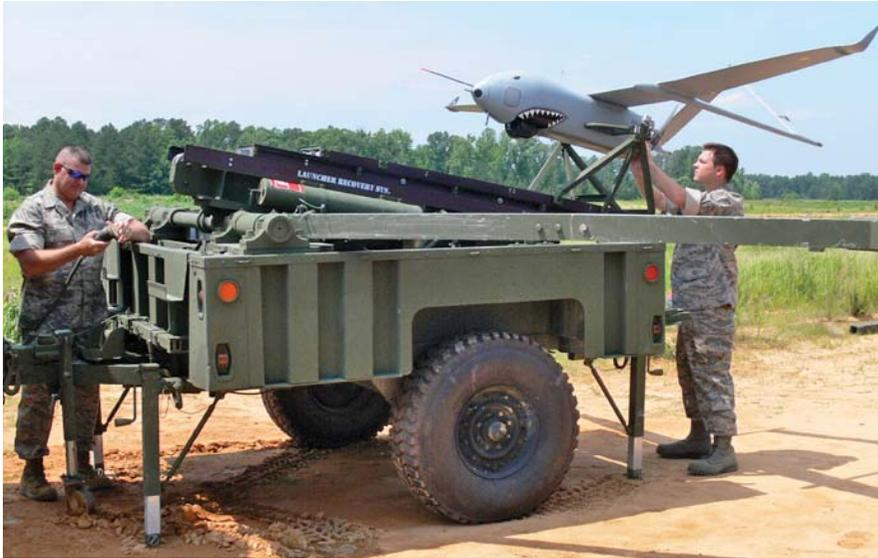
המיני-כטב"ם Aerosonde Mk 4.7 על המשגר הנגרר שלו.
