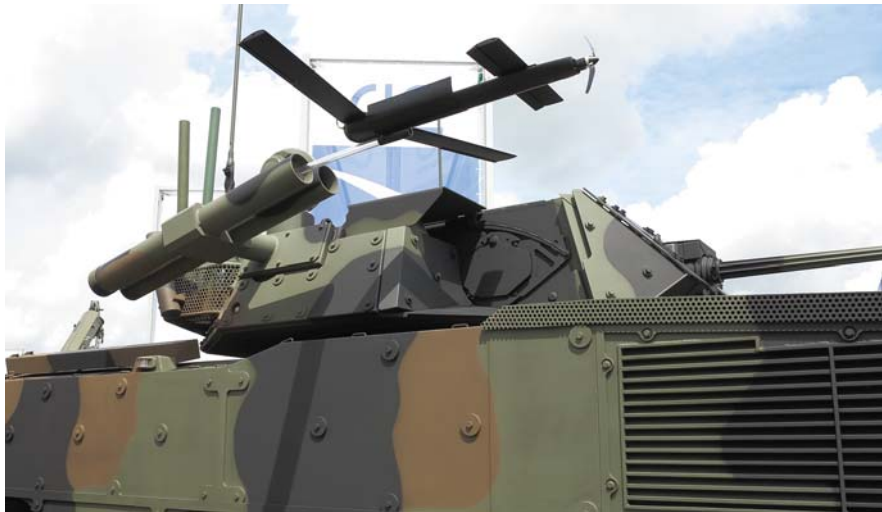
המיני-כטב"ם האיטלקי Horus משגר מצינורות המותקנים בצדי הצריח של כלי-הרכב המשוריין.
