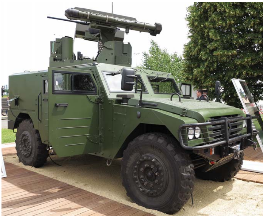
למעלה: המשאית נושאת המשגר של מערכת ההגנה האווירית SAMP/T (מאמבה) ודגם של הטיל הדור-שליבי אסטר 30. למטה: צריח נושא טילי נ"מ מיסטרל 2 על רכב משוריין (מערכת MPCV). הצריח מתאים גם להפעלת טילי נ"ט דוגמת MMP, כפי שהוצג בתערוכה.
