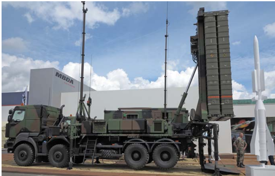
למעלה: המשאית נושאת המשגר של מערכת ההגנה האווירית SAMP/T (מאמבה) ודגם של הטיל הדור-שליבי אסטר 30. למטה: צריח נושא טילי נ"מ מיסטרל 2 על רכב משוריין (מערכת MPCV). הצריח מתאים גם להפעלת טילי נ"ט דוגמת MMP, כפי שהוצג בתערוכה.
