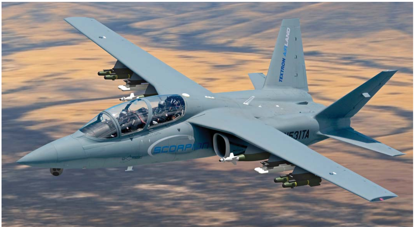
הסקורפיון של טקסטרוֹן אייר-לנד מדגים נשיאת טילי הלפיר ופצצות מונחות-לייזר בניסויים בארה"ב. מתחת לחרטומו נראה צריח התצפית האלקטרו-אופטי.
